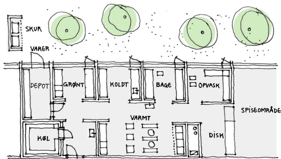
Skitse 5: Eksempel på disponering af et produktionskøkken for en madskole med vareindlevering gennem depot, zoneopdeling i produktionsområde og spiseområde med disk.
